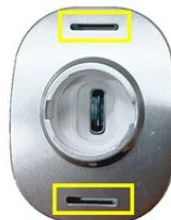
Obrázek 8 Přívod vzduchu – IS 3800
