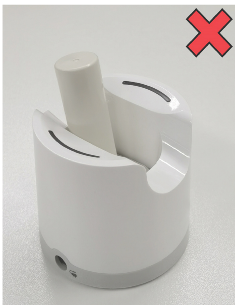
Obrázek 9 Nesprávné použití nabíjecí stanice
