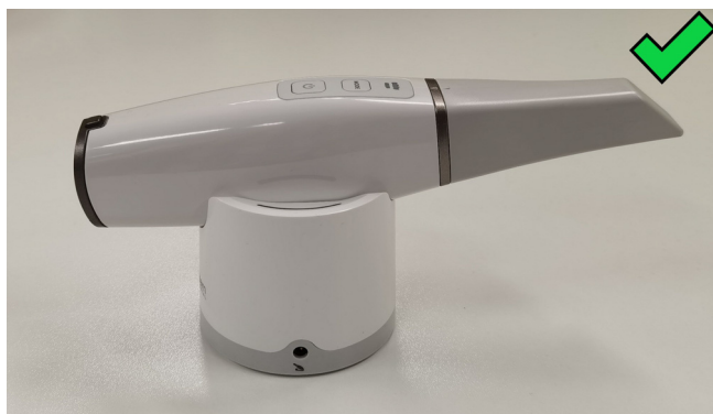
Obrázek 5 Skener IS 3800W umístěný v nabíjecí stanici ve vodorovné poloze (s násadou směřující nahoru)
